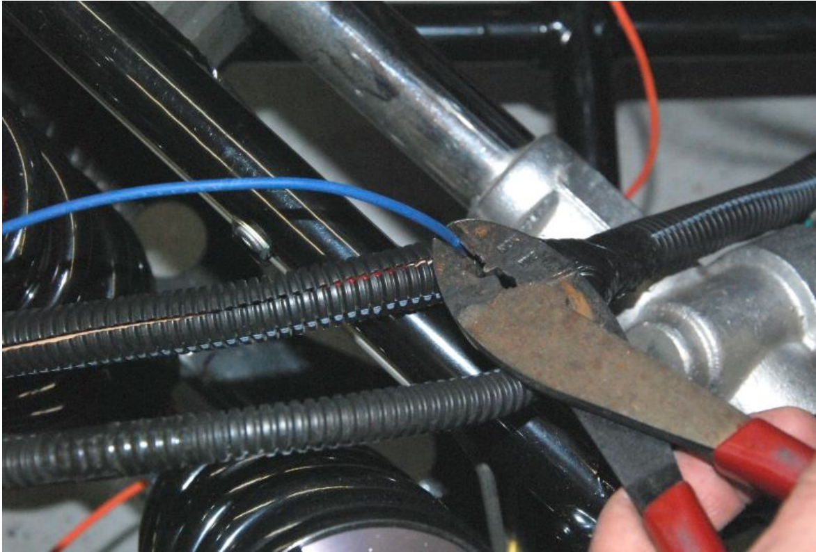
Cut the blue fan wire.
