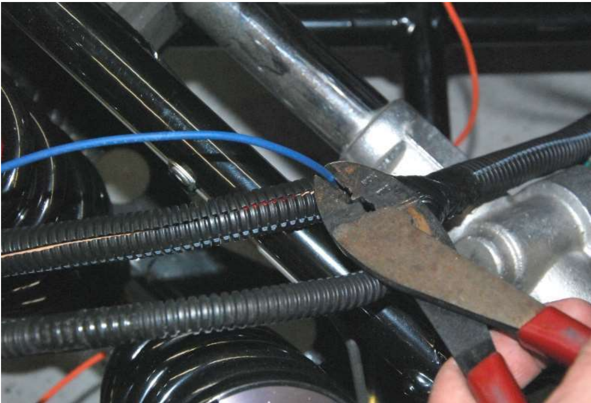
Cut the blue fan wire.
