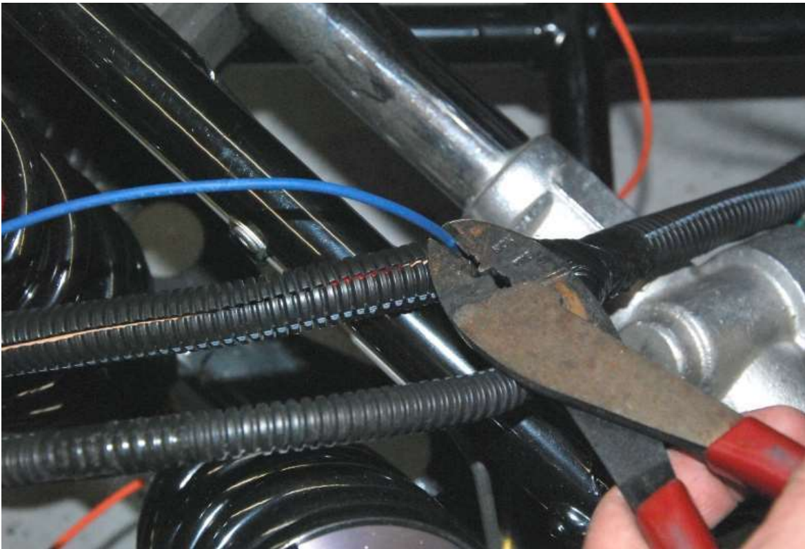
Cut the blue fan wire.
